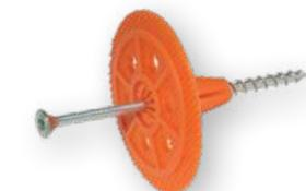
Βιδωτό βύσμα με γαλβανιζέ βίδα για επιφανειακές στηρίξεις του θερμομονωτικού υλικού. Εφαρμογές σε: Ξύλο, OSB, Ινσανίδα ή Τιμεντοσανίδα. Διάμετρος ροδέλας: 60mm. Ελάχιστο βάθος αγκύρωσης: 25mm.
