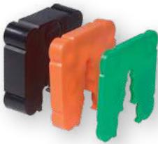
Πλαστικά προφίλ για την πλήρωση του διάκενου μεταξύ υποστρώματος και μεταλλικού οδηγού εκκίνησης στα σημεία στερέωσής του, για αλφάδιασμα της τοικοποιίας. Τοποθετείται με απλό κούμπωμα στο βύσμα και έχουν τη δυνατότητα του μεταξύ τους συνδυασμού για μεγαλύτερα πάχη.
