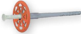
Καρφωτό βύσμα για τούβλο, σκυρόδεμα και άλλα συμπαγή και διάτρητα δομικά υλικά με ενισχυμένη πλαστική καρφίδα για επιφανειακές στηρίξεις του θερμομονωτικού υλικού. **Πιστοποιημένο κατά EAD 330196-01-0604.** Διάμετρος βίδας: 8mm. Διάμετρος ροδέλας: 60mm. Ελάχιστο βάθος αγκύρωσης: 35mm.
